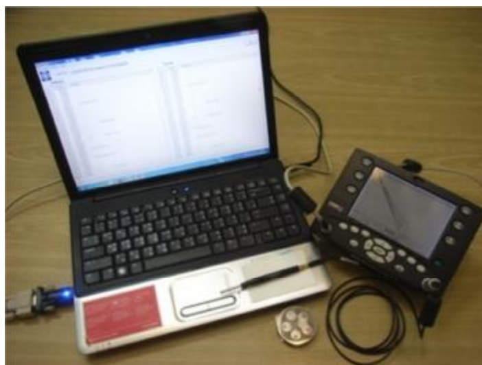
รูปที่ 3.17 ชุดเครื่องมือวัดกระแสไหลวน และการติดต่อกับเครื่องผ่าน RS232 Port
