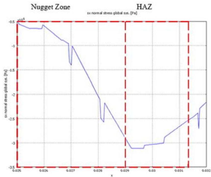
รูปที่ 4.3 แสดงผลการวิเคราะห์ความเค้นของชิ้นงาน 14 kA โดย FEM
