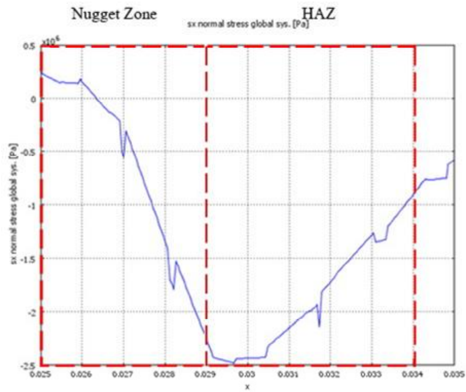
รูปที่ 4.2 แสดงผลการวิเคราะห์ความเค้นของชิ้นงาน 12 kA โดย FEM
