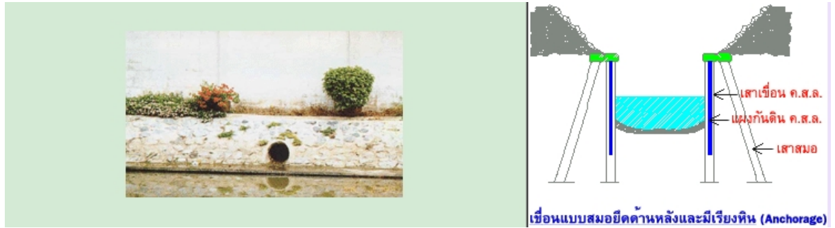
รูปที่ 2.4 แสดงเขื่อนแบบสมอยึดด้านหลังและมีเรียงหิน
