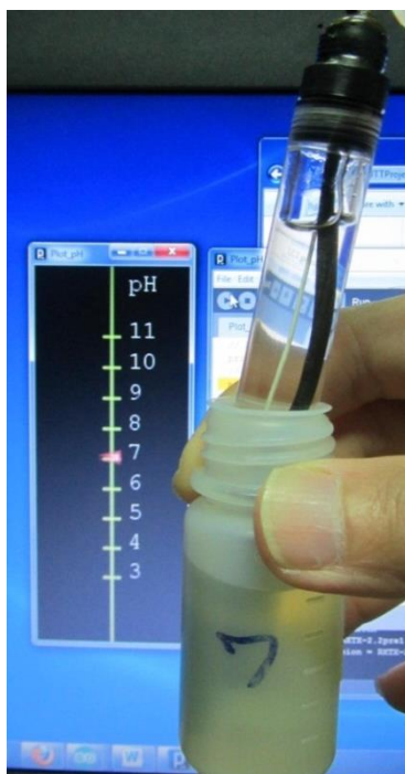
รูปที่ 6.34 การวัดค่า pH ด้วยเซนเซอร์ชนิด ISFET ของสารละลายสามชนิดที่มีค่า \text{pH} = 4, 7, 10
