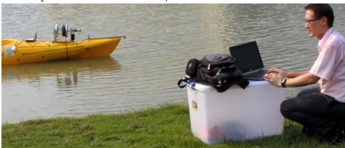
รูปที่ 6.40 แสดงการควบคุมการหย่อนหัววัดคุณภาพน้ำจากคอมพิวเตอร์ที่ชายฝั่งผ่านเครือข่ายอินเทอร์เน็ตแบบ 3G
