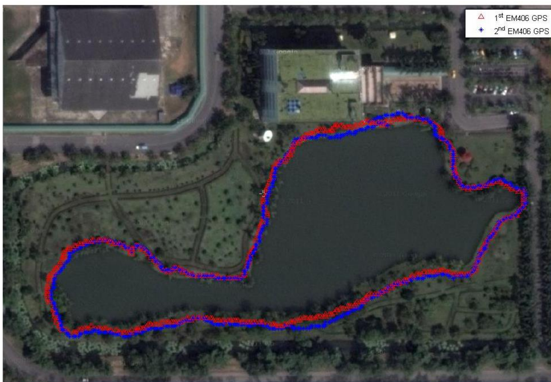
รูปที่ 6.13 พิกัดหรือตำแหน่งที่วัดได้ในรูปแบบของละติจูดและลองจิจูดที่ได้จาก GPS EM-406 A จำนวนสองตัว ที่นำมาวางดลงบน Google Earth ในพื้นที่ประเภทที่ 3 บริเวณรอบสระน้ำข้างอาคารวิทยบริการ
