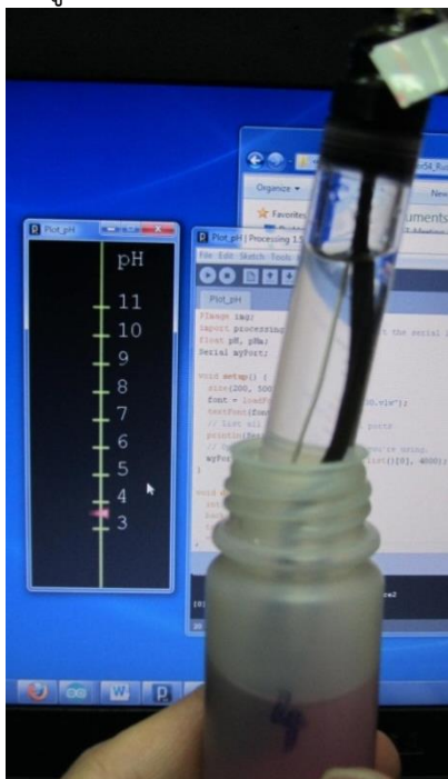
รูปที่ 6.34 การวัดค่า pH ด้วยเซนเซอร์ชนิด ISFET ของสารละลายสามชนิดที่มีค่า \text{pH} = 4, 7, 10
