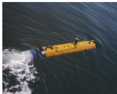
รูปที่ 3.6 หุ่นยนต์ใต้น้ำจากบริษัท ที่ได้ติดตั้งหัววัดพารามิเตอร์ทางสิ่งแวดล้อมของ YSI
