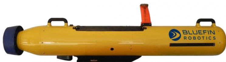
รูปที่ 3.6 หุ่นยนต์ใต้น้ำจากบริษัท ที่ได้ติดตั้งหัววัดพารามิเตอร์ทางสิ่งแวดล้อมของ YSI
