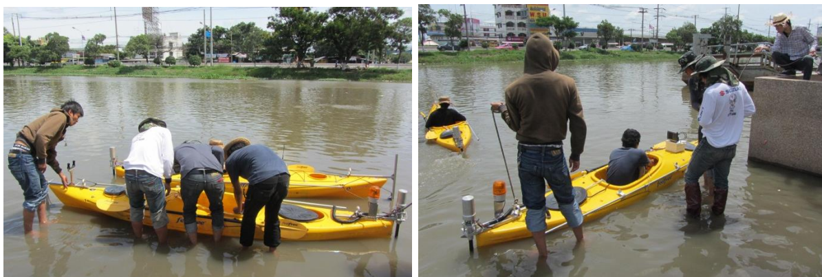
รูปที่ 5.48 การนำเรือเข้าเทียบท่าเพื่อทำการเปลี่ยนแบตเตอรี่ ในคลองรังสิตประยูรศักดิ์
