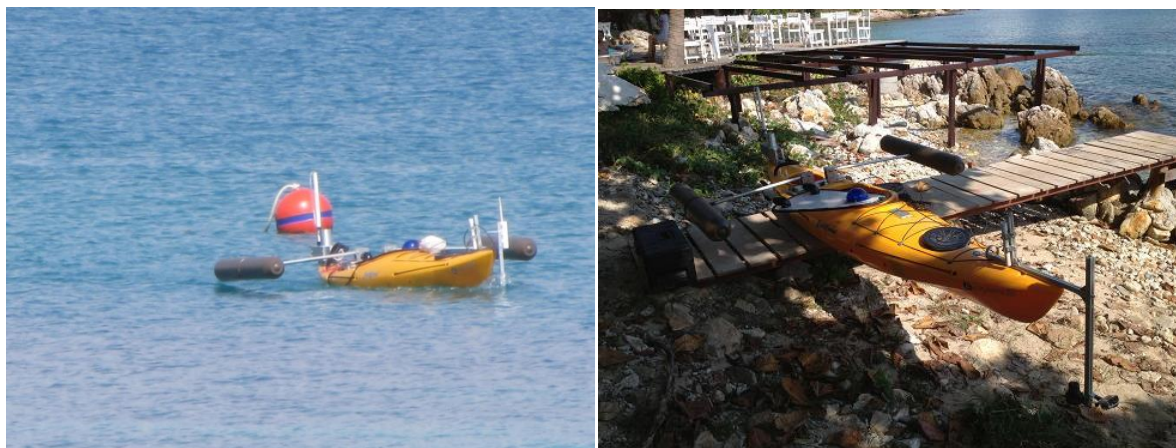
รูปที่ 6.3 ภาพการทดสอบระบบหุ่นยนต์เรือในทะเล ณ อ่าวปะการัง เกาะเสม็ด จังหวัดระยอง ด้านหน้าเรือติดตั้งหัวหยั่งความลึกของน้ำด้วยเสียงและกล้องถ่ายภาพใต้น้ำ
