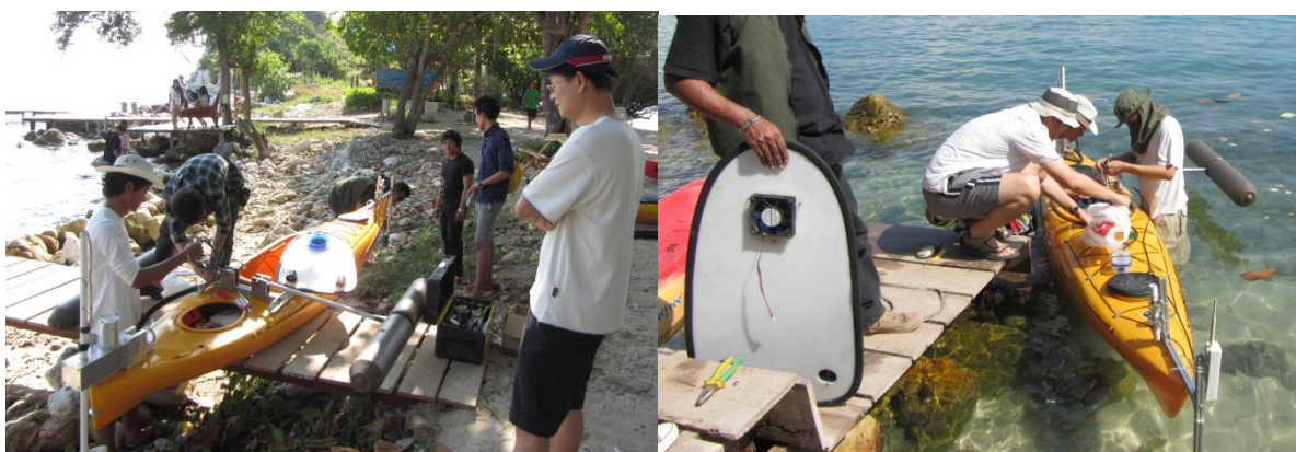
รูปที่ 6.5 การประกอบกลไกชุดขับเคลื่อนสำหรับลงทะเลทางท้ายเรือและทูลอยช่วยการทรงตัวเข้ากับเรือคายัค (ซ้าย) และ การติดตั้งระบบนำร่องและตรวจสอบความพร้อมก่อนทำการทดสอบจริง (ขวา)
