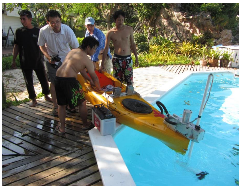
รูปที่ 5.36: การทดสอบกลไกขับเคลื่อนทางกลสำหรับชุดขับเคลื่อนท้ายเรือที่จะใช้ลงทะเลในสระว่ายน้ำ
