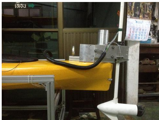
รูปที่ 5.35: การออกแบบกลไกการพับชุดขับเคลื่อนท้ายเรือให้พ้นเหนือน้ำ
