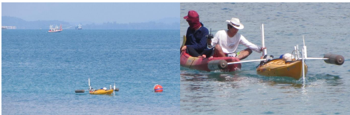
รูปที่ 6.6 การทดสอบเรือเพื่อเก็บค่าความลึกของอ่าวปะการัง ที่เกาะเสม็ด โดยการเคลื่อนที่แบบอัตโนมัติตามจุดพิกัด GPS ที่กำหนด (ซ้าย) และ เรือพี่เลี้ยงที่ช่วยแก้ไขระบบอยู่ในทะเล (ขวา)
