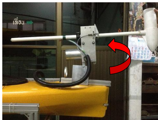
รูปที่ 5.35: การออกแบบกลไกการพับชุดขับเคลื่อนท้ายเรือให้พ้นเหนือน้ำ
