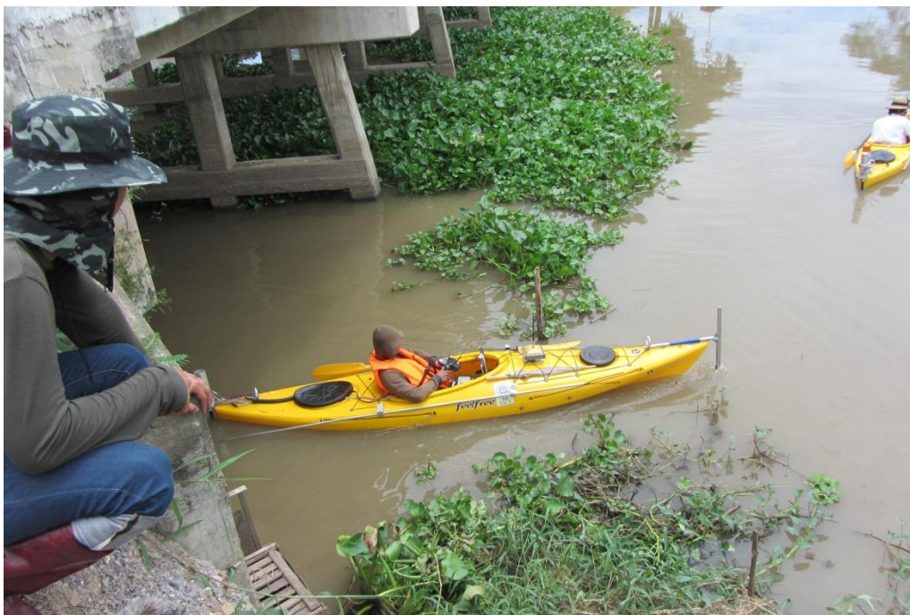
รูปที่ 5.44 การลงสำรวจคลองรังสิตประยูรศักดิ์ ที่ต้องมีการหลบหลีกอุปสรรค เช่น สะพานและกอผักตบชวา โดยใช้วิทยุบังคับในการควบคุมการเคลื่อนที่ของเรือคายัค
