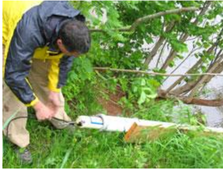
รูปที่ 1. การติดตั้งเครื่องมือตรวจวัดคุณภาพน้ำแบบอัตโนมัติ และการปรับใช้เซนเซอร์เป็นหุ่นในปากของเฟรเซอร์เวอร์
