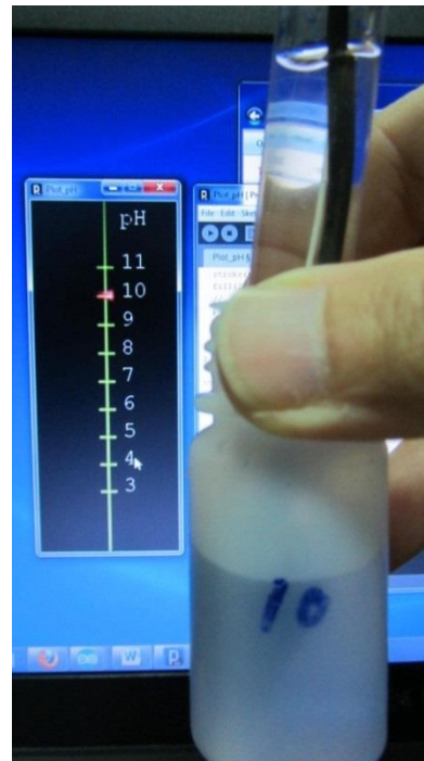
รูปที่ 6.34 การวัดค่า \text{pH} ด้วยเซนเซอร์ชนิด ISFET ของสารละลายสามชนิดที่มีค่า \text{pH} = 4, 7, 10
