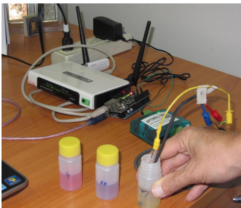
รูปที่ 6.36 การส่งข้อมูลคุณภาพน้ำจากเซนเซอร์ชนิด ISFET ผ่าน Pachube Web Server โดยใช้ 3G Router และ Arduino Ethernet Shield
