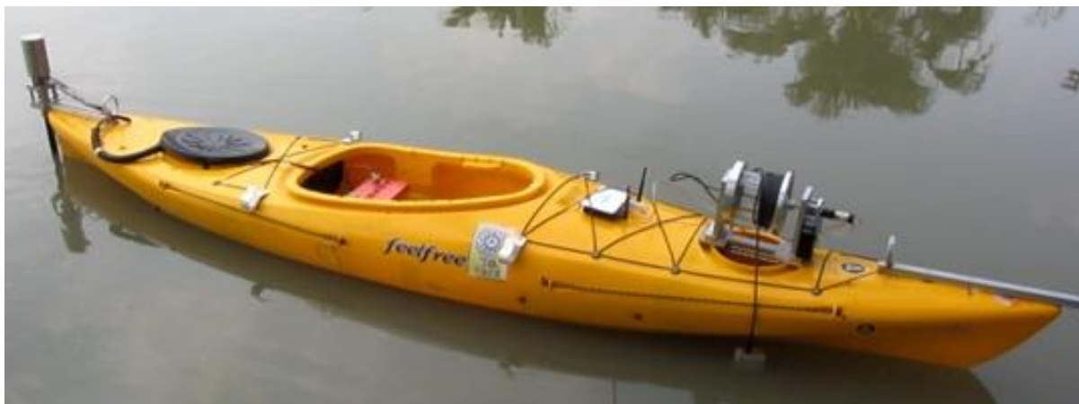
รูปที่ 6.38 การติดตั้งเครื่องหย่อนหัววัดคุณภาพน้ำและ 3G wireless router เข้ากับเรือคายัค
