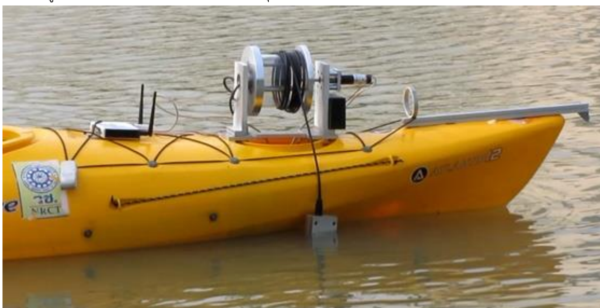
รูปที่ 6.39 การทดสอบการหย่อนหัววัดคุณภาพน้ำจากที่ผิวน้ำไปยังความลึกที่ต้องการ
