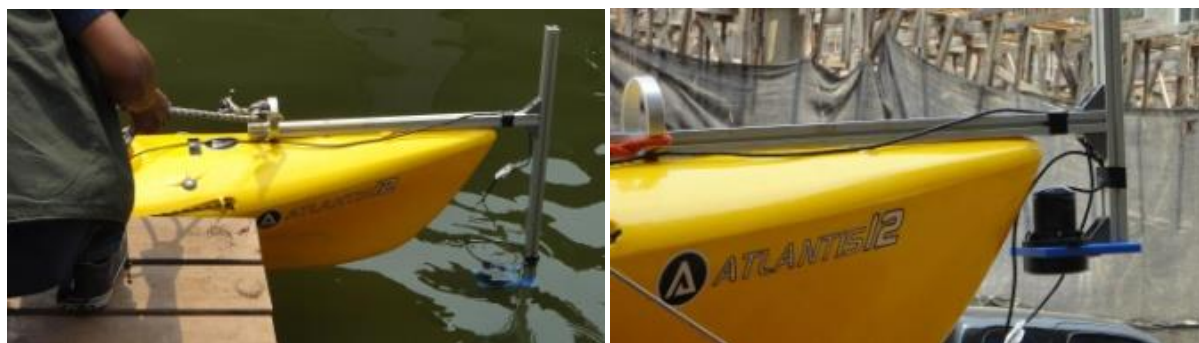
รูปที่ 5.18 หัววัดความลึกท้องน้ำและการติดตั้งทางด้านหัวเรือคายัคเมื่อนำเรือออกปฏิบัติการ (ซ้าย) และ เมื่อนำเรือเข้าเทียบท่า (ขวา)
