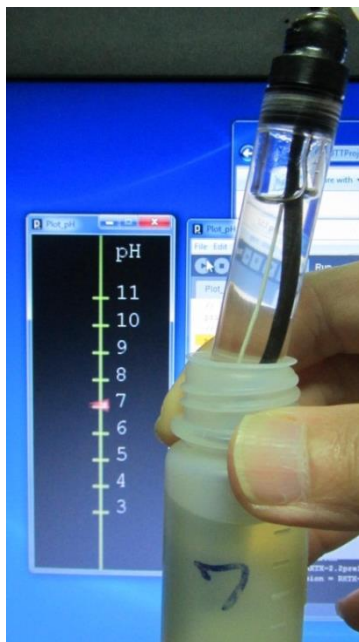
รูปที่ 5.16 : โปรแกรมที่ใช้ในการบ่งบอกค่าพีเอชของน้ำที่ได้ถูกพัฒนาขึ้นด้วยโปรแกรม Processing ที่เชื่อมต่อข้อมูลมาจาก Arduino microcontroller
