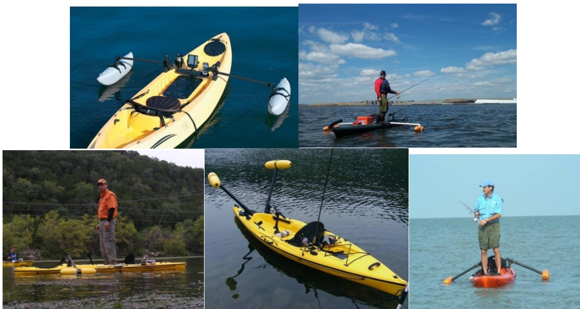
รูปที่ 3.2: การเสริมทุ่นสองข้างเรือคายัค เพื่อเพิ่มสมรรถนะการดำน้ำคลื่อนในขณะปฏิบัติการ [12]
