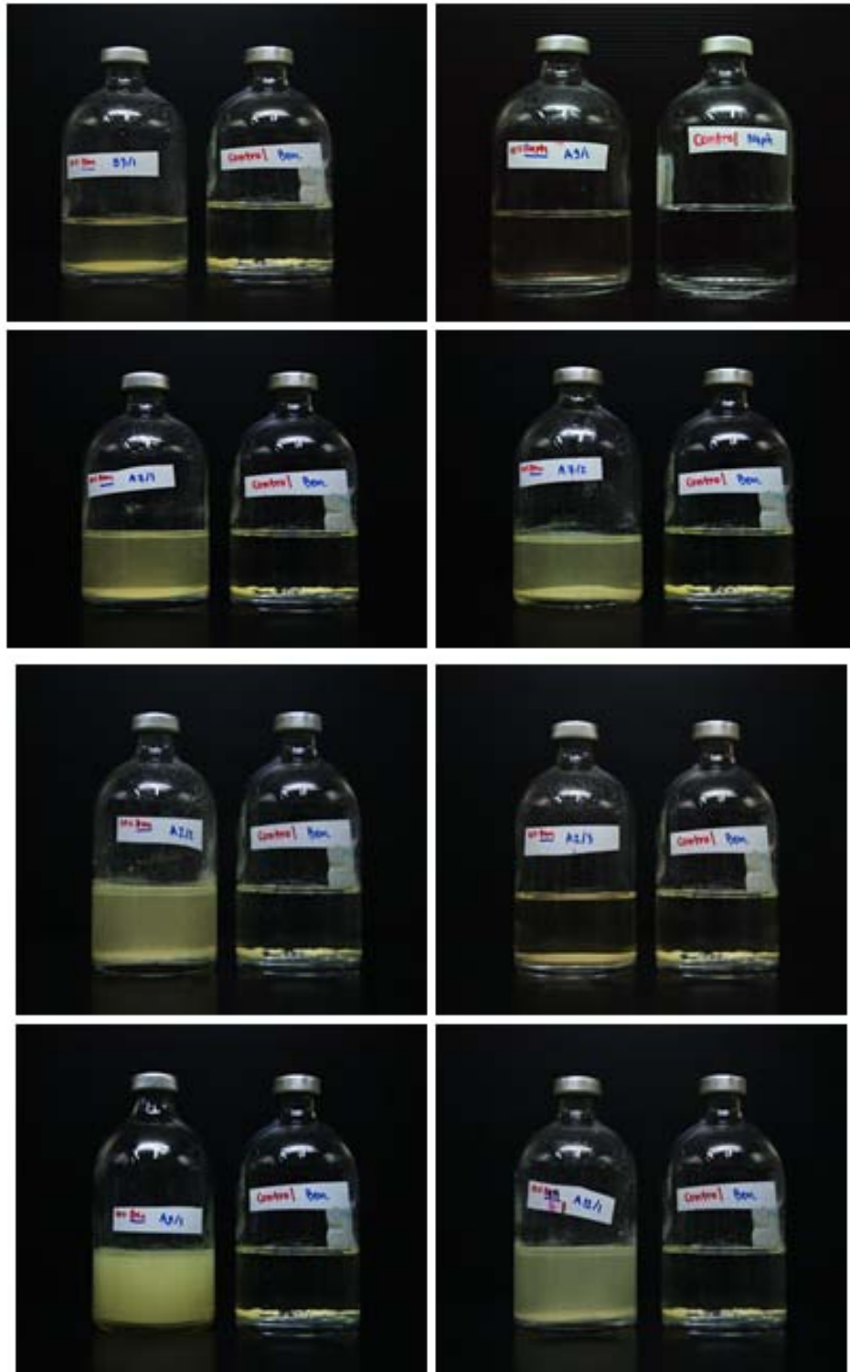
ภาพที่ 4.17 สภาพการละลายของ PAHs ในอาหารเลี้ยงเชื้อที่ใช้แหล่งคาร์บอนคือ Benzo[a]pyrene ที่ความเข้มข้น 200 ppm เมื่อมีการลงเชื้อที่ความเข้มข้น 5% (ซ้าย) เปรียบเทียบกับชุดควบคุมที่ไม่ได้เชื้อ (ขวา) เป็นเวลา 8 วัน ที่ 37 องศาเซลเซียส
