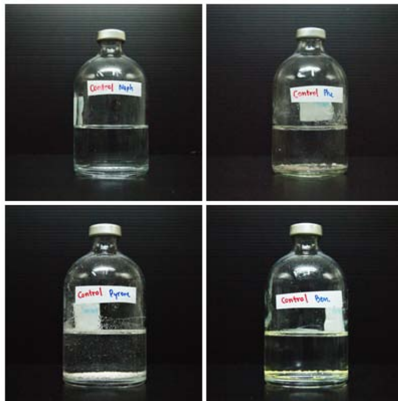
ภาพที่ 4.13 ความสามารถในการละลายของ PAHs ทั้ง 4 ชนิดคือ Naphthalene, Phenanthrene, Pyrene และ Benzo[a]pyrene ที่ความเข้มข้น 200 ppm ในอาหารเลี้ยงเชื้อ
