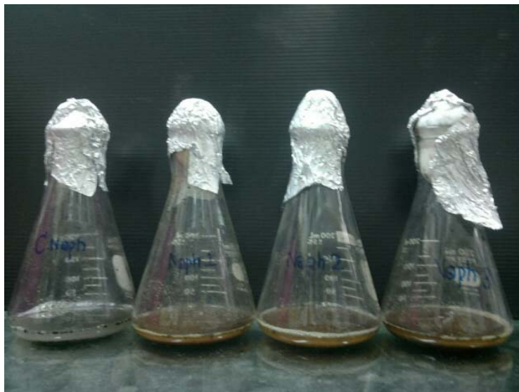
ภาพที่ 3.25 การย่อยสลายสารโพลีอะโรมาติกไฮโดรคาร์บอนด้วยแลกเคลส
