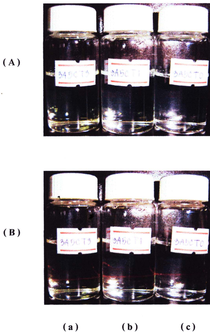
รูปที่ 3-52 ลักษณะของอนุภาคในระบบตัวทำละลาย Water-Tween ที่มองเห็นเมื่อไม่ผ่านแสงเลเซอร์ (A) และเมื่อผ่านแสงเลเซอร์ (B) เมื่อความเข้มข้นของ Quercetin เป็น (a) = 0.3 มิลลิกรัม/มิลลิลิตร, (b) = 0.2 มิลลิกรัม/มิลลิลิตร, (c) = ไม่มี Quercetin
