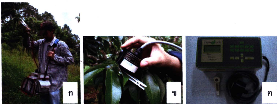
ภาพที่ 9 การวัดอัตราการสังเคราะห์แสง ค่าประสิทธิภาพของปากใบ อัตราการคายน้ำของใบโดยเครื่อง Portable Photo System รุ่น LCA-4 (ก) และการวัดประสิทธิภาพการทำงานของคลอโรฟิลล์ของใบพืชด้วยเครื่อง Chlorophyll Fluorescence (ข และ ค)
