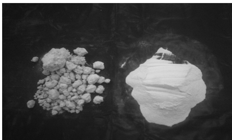
รูปที่ 3.7 ลักษณะดินขาวที่ร่อนผ่านตะแกรงเบอร์ 40 และดินขาวธรรมชาติของ ตำบลโนนทอง อำเภอนาูง จังหวัดอุดรธานี
