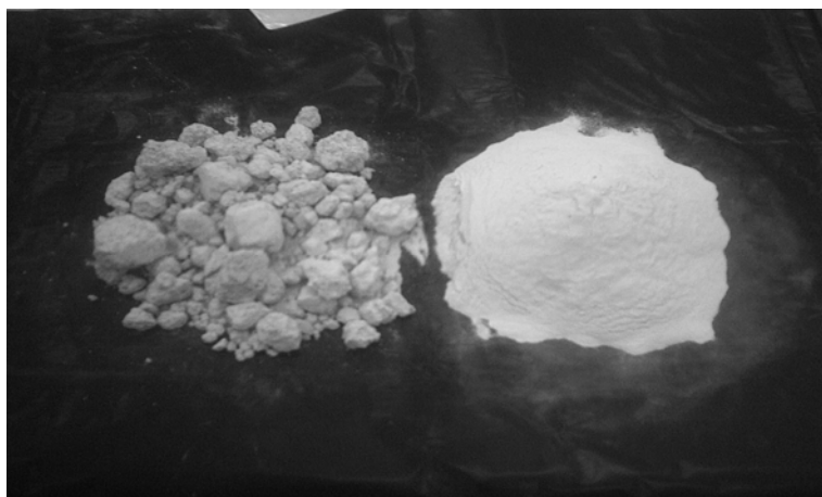
รูปที่ 3.12 ลักษณะดินขาวที่ร่อนผ่านตะแกรงเบอร์ 40 และดินขาวธรรมชาติของ ตำบลหาดส้มแป้น อำเภอเมือง จังหวัดระนอง
