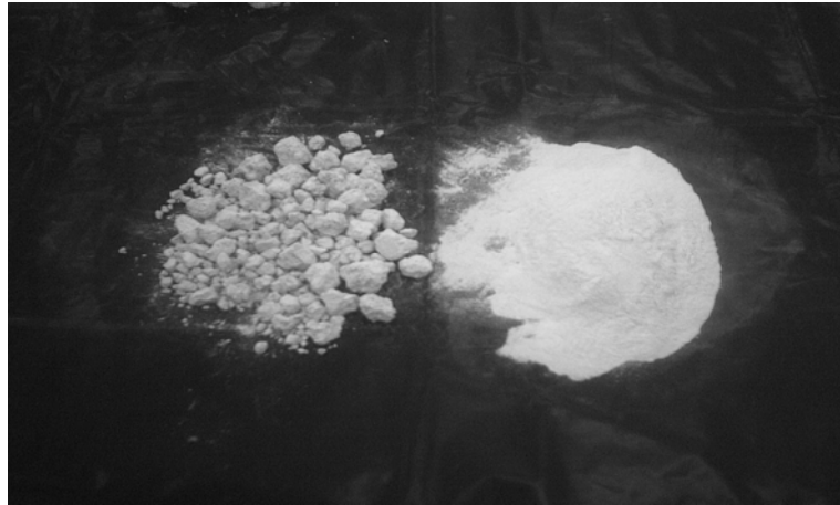
รูปที่ 3.14 แสดงลักษณะดินขาวที่ร่อนผ่านตะแกรงเบอร์ 40 และดินขาวธรรมชาติของ ตำบลดจวบ อำเภोजะเอยรื่อง จังหวัดนราธิวาส
