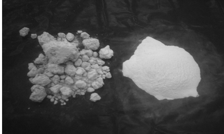
รูปที่ 3.10 ลักษณะดินขาวที่ร่อนผ่านตะแกรงเบอร์ 40 และดินขาวธรรมชาติของ ตำบลวังจันทร์ อำเภอกำแพงกระเจาน จังหวัดเพชรบุรี
