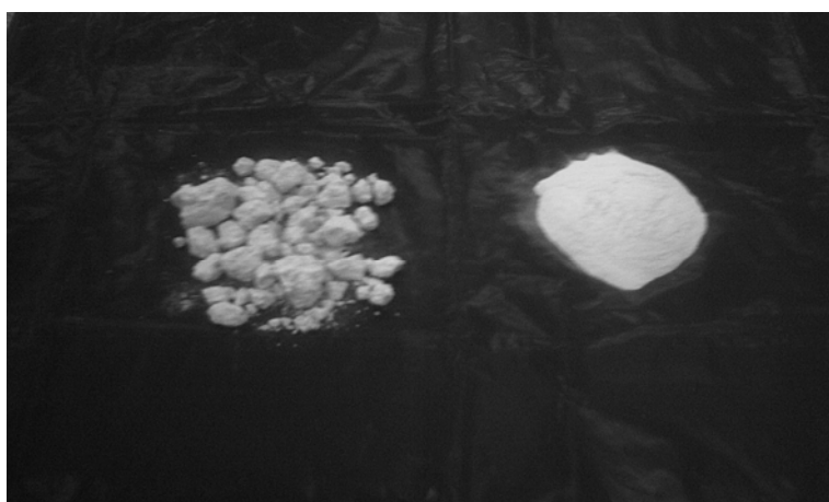
รูปที่ 3.13 แสดงลักษณะดินขาวที่ร่อนผ่านตะแกรงเบอร์ 40 และดินขาวธรรมชาติของ ตำบลขุนทะเล อำเภอเมือง จังหวัดสุราษฎร์ธานี
