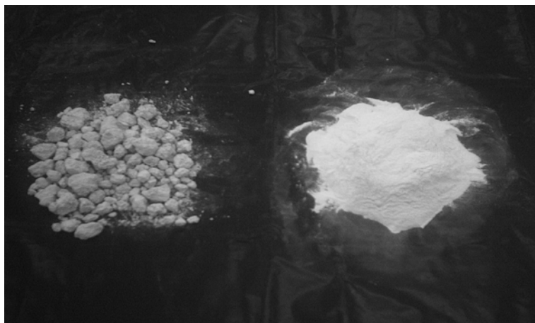
รูปที่ 3.4 ลักษณะดินขาวที่ร่อนผ่านตะแกรงเบอร์ 40 และดินขาวธรรมชาติของตำบลทุ่งฝาย อำเภอเมือง-แจ้ห่ม จังหวัดลำปาง
