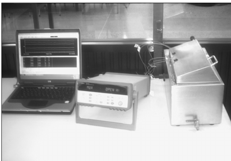
รูปที่ 3.29 แสดงตัวอย่างการทดสอบแคลอริเมตรี
