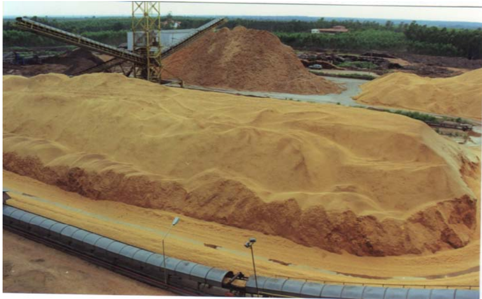
รูปที่ 3.1 กองแกลบและเปลือกไม้ที่ใช้เป็นวัตถุดิบในการเผา
