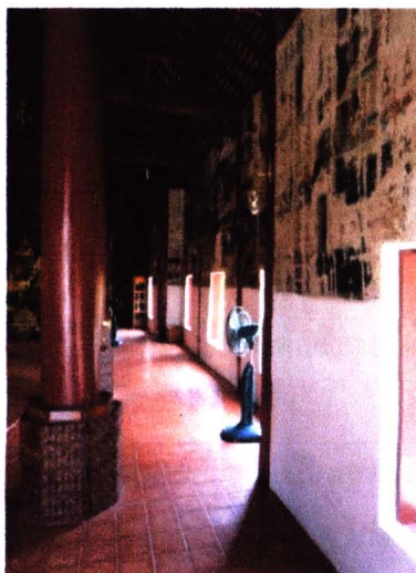
ภาพ 4-102, 103 วิหารวัดเสาหิน ติดตั้งพัดลมแขวนผนังด้านที่ไม่มีจิตรกรรม ด้านที่มีจิตรกรรมใช้พัดลมตั้งพื้น (ที่มา : การลงพื้นที่สำรวจ 5-4-53)
