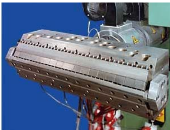
ภาพที่ 1-1 รูปร่างภายนอกของแม่พิมพ์อัดรีดที่ใช้สำหรับฉีดพลาสติกแผ่น
