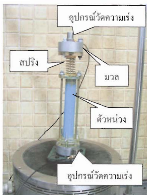
ภาพที่ 3-3 ระบบมวล สปริงและตัวหน่วง
