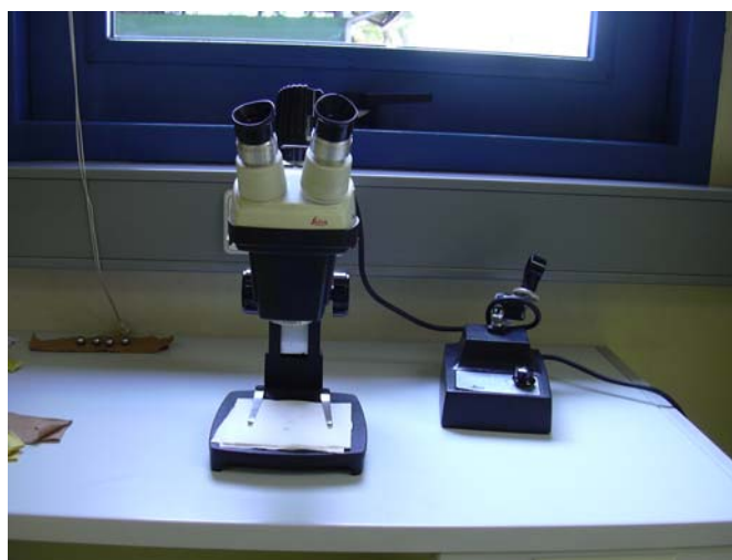
ภาพที่ ข-8 เครื่องทดสอบ Microscope ใช้หาการสึกกร่อนซึ่งมีความถูกต้องถึง 0.01 มิลลิเมตร
