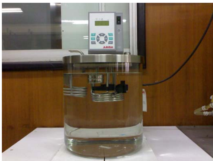
ภาพที่ ข-14 เครื่อง CANNON-FENSKE ROUTINE TYPE ใช้ทดสอบค่าความหนืด ในการหาการเกิดปฏิกิริยาออกซิเดชัน
