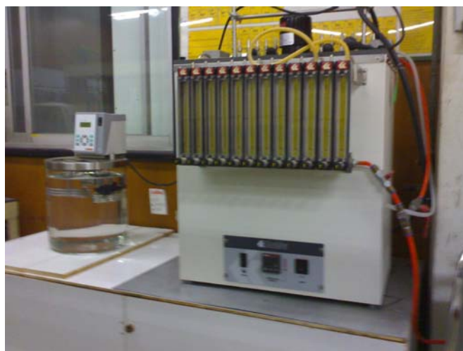
ภาพที่ ข-16 เครื่องทดสอบค่าความหนืดที่เปลี่ยนไป เมื่อมีการเกิดปฏิกิริยาออกซิเดชั่น
