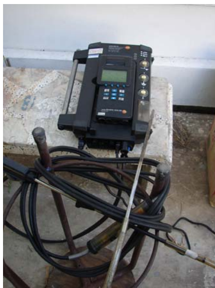
ภาพที่ ข-18 เครื่อง testo 350-XL ใช้วัดก๊าซที่ออกมาจากท่อไอเสียรถจักรยานยนต์
