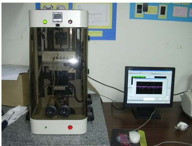
ภาพที่ ข-11 เครื่อง Tribometer ของบริษัท CETR พร้อมการหาค่าสัมประสิทธิ์แรงเสียดทาน และการสึกหรอ
