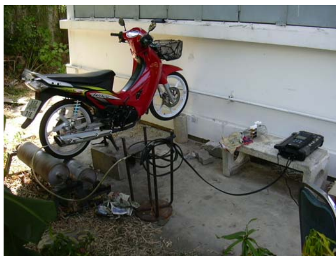
ภาพที่ ข-20 การต่อเครื่องวัดก๊าซที่ท่อไอเสียรถจักรยานยนต์
