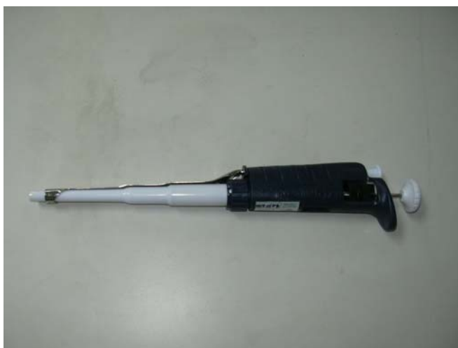
ภาพที่ ข-13 เครื่องมือในการหยดน้ำมันหล่อลื่นที่ใช้ในการทดสอบ ความละเอียด 100 ไมโครลิตร
