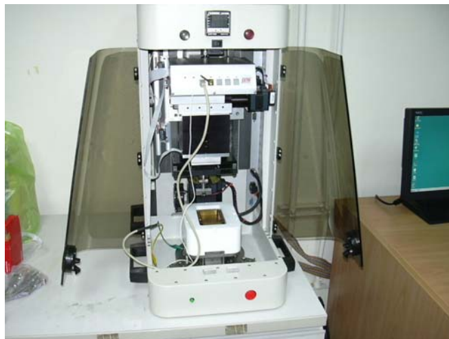
ภาพที่ ข-10 เครื่อง Tribometer ของบริษัท CETR ใช้ทดสอบสัมประสิทธิ์แรงเสียดทาน และการสึกหรอ
