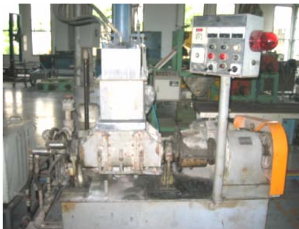
ภาพที่ 3-2 เครื่องบดผสมยาง (Dispersion Kneader Machine)
