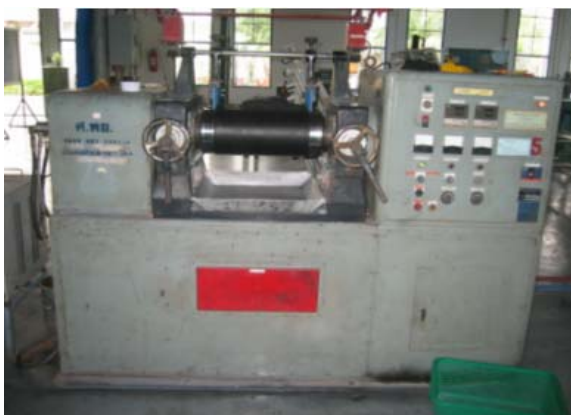
ภาพที่ 3-3 เครื่องบดผสมแบบ 2 ลูกกลิ้ง (Two Roll Mill)
