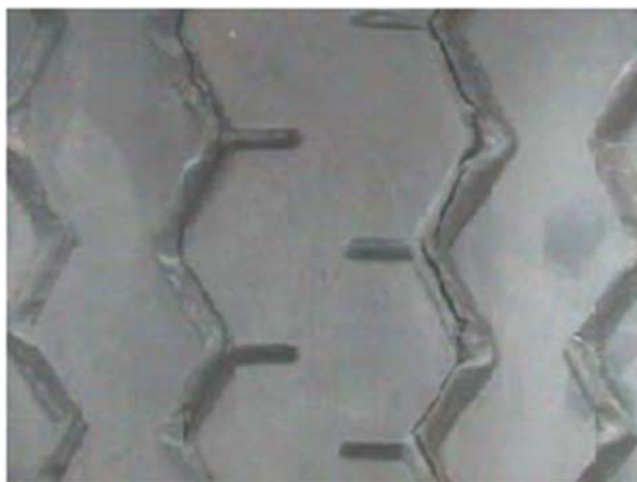
ภาพที่ 6-2 รอยฉีกขาดในร่องดอกยาง (Groove Cracking) [34]
