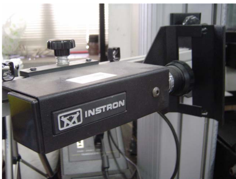
ภาพที่ 3-8 อุปกรณ์วัดระยะยืดวิดีโอเอกซ์เทนโซมิเตอร์
