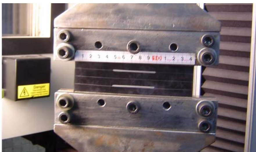
ภาพที่ 3-12 ชั้นทดสอบแบบความกว้างคงที่ (Planar Test)
