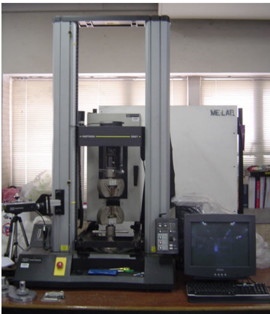
ภาพที่ 3-7 เครื่องทดสอบ Instron Universal Testing Machine Model 5567
