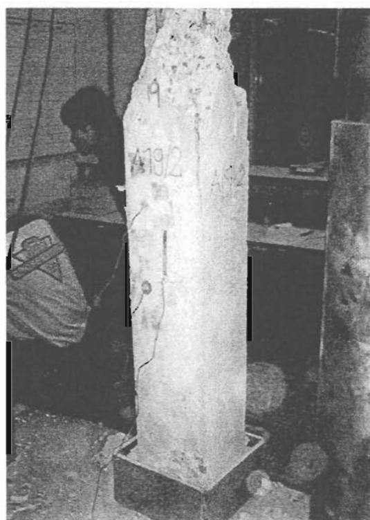
ภาพที่ 4-6 การวิบัติของเสา A19/2
