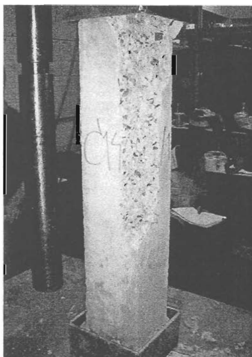
ภาพที่ 4-41 การวิบัติของเสา C14/1
