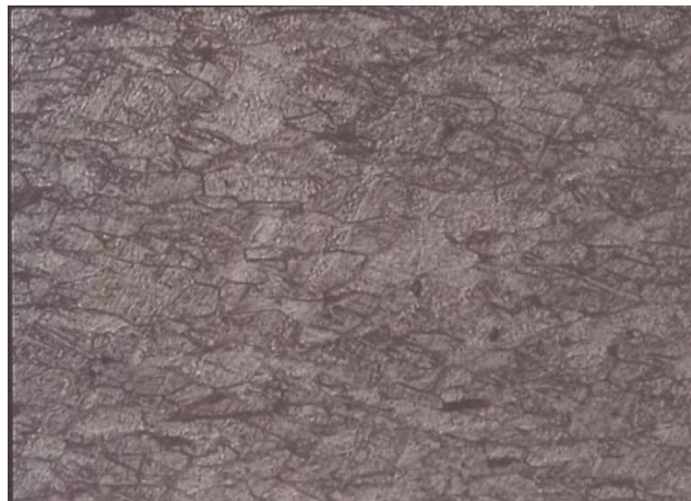
ค) เกรนแนวภาคตัดชิ้นงาน กำลังขยาย 200 เท่า
