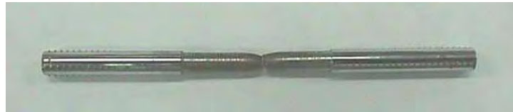
รูปที่ ข.1 แสดงชิ้นงานทดสอบแรงดึง
