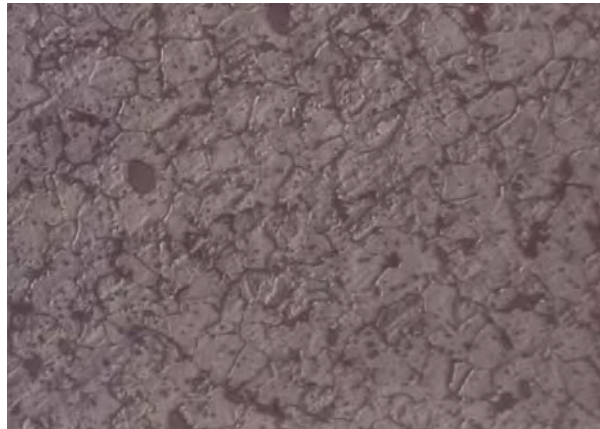
ก) เกรนแนวภาคตัดชิ้นงาน กำลังขยาย 500 เท่า
