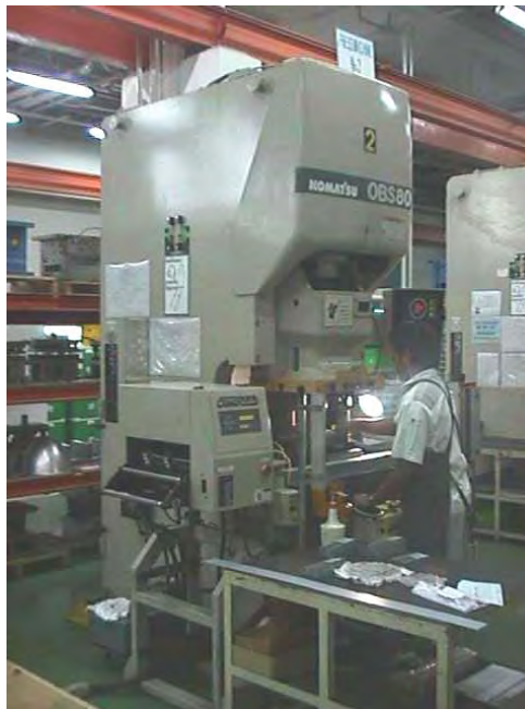
รูปที่ ก.1 เครื่อง Pressing ขนาด 80 ตัน
