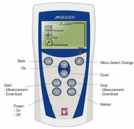
ภาพที่ ญ-1 เครื่องวัดค่าสัญญาณไฟฟ้ากล้ามเนื้อ EMG
