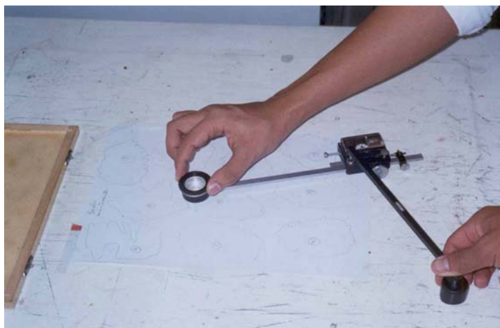
ภาพที่ 3-3 การวัดหาพื้นที่ผิวของปลาหมึกโดยใช้ Polar Planimeter
