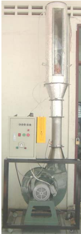
ภาพที่ 3-6 ชุดทดลองสะพานเต็ดเบดที่ออกแบบด้วยการไหลแบบคงตัว[3]
