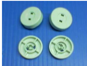
(ข) แสดงชิ้นส่วน Leg stand หลังการปรับปรุงที่ประกอบด้วยวิธีการกดยึด
