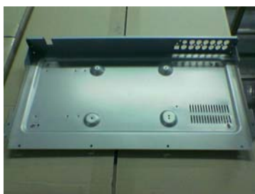
(ข) การออกแบบใหม่ โดยการป้อนชิ้นฐานรองมากับ Bottom case หลังการปรับปรุง
