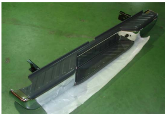
ภาพที่ 3-2 ชิ้นส่วนกันชนหลังรถยนต์ที่ทำการชุบโครเมียม
