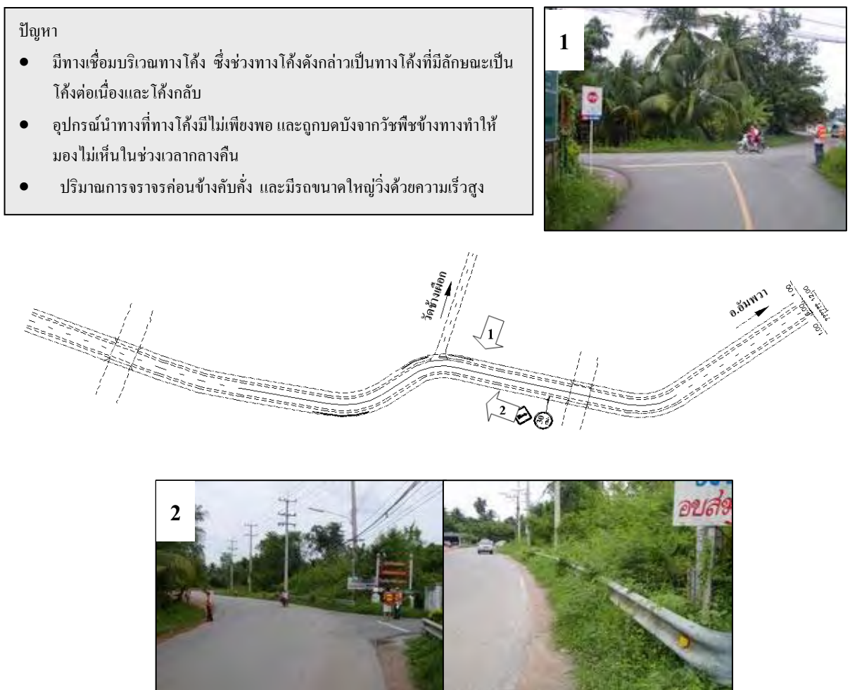
รูปที่ 4.53 สภาพปัจจุบันบริเวณทางแยก กม.1+050
