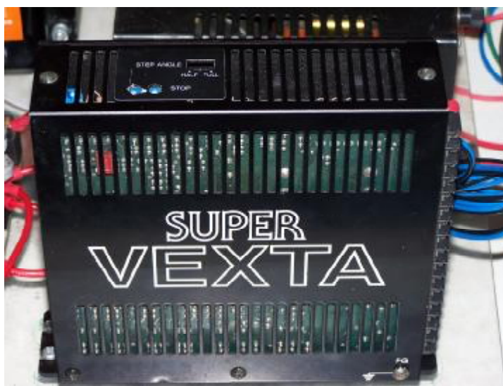
ภาพที่ 3-7 อุปกรณ์ควบคุมสเตปมอเตอร์
