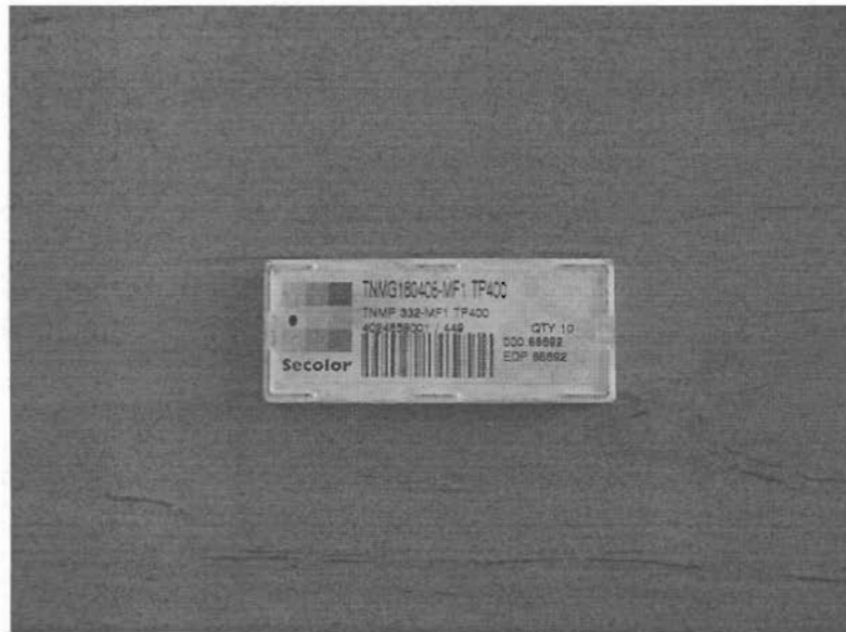
ภาพที่ 3-24 เม็ดมีดกลึง ยี่ห้อ SECO รุ่น TNMG 160408-MF1 เกรด TP400
