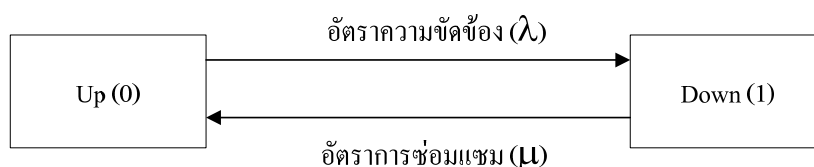
ภาพที่ 1-1 แบบจำลองสถานะของอุปกรณ์
