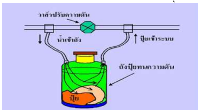
ภาพที่ 2.6 อุปกรณ์ฉีดปุ๋ยท่อ
