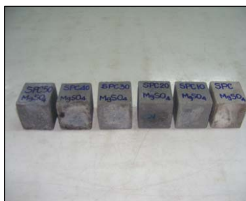
ภาพที่ ง.12 ตัวอย่างทดสอบแชนสารละลาย แมกนีเซียมซัลเฟต
