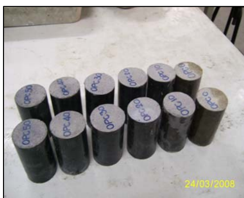
ภาพที่ ง.17 ก่อนตัวอย่างที่ผ่านการเคลือบด้วย Epoxy เพื่อทดสอบหาปริมาณคลอไรด์
