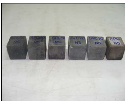
ภาพที่ ง.11 ตัวอย่างทดสอบแชนสารละลาย โซเดียมซัลเฟต
