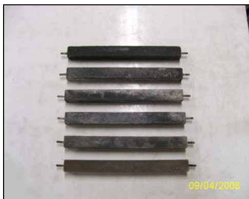
ภาพที่ ง.13 ตัวอย่างทดสอบการเปลี่ยนแปลง ความยาวเส้นสารละลายไฮเดียมซัลเฟต
