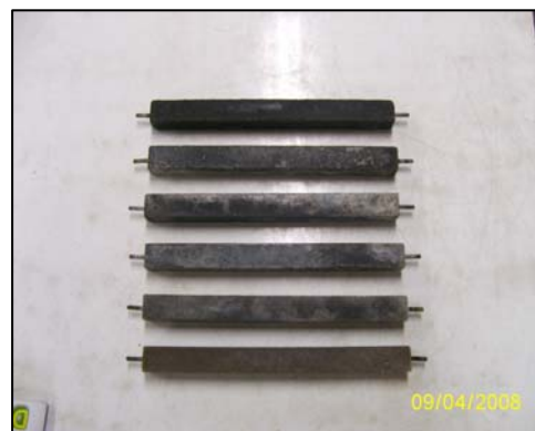
ภาพที่ ง.14 ตัวอย่างทดสอบการเปลี่ยนแปลง ความยาวเส้นสารละลายแมกนีเซียมซัลเฟต
