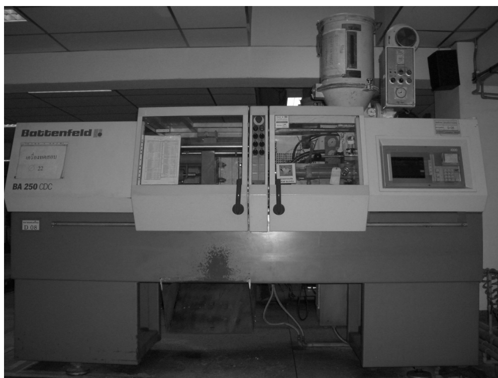
ภาพผนวกที่ ก1 เครื่องฉีดพลาสติกกรุ่น BA 250/50 CDC
