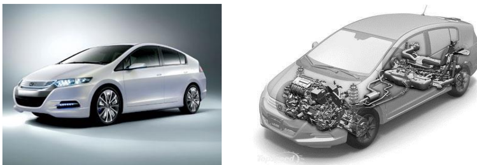
รูปที่ 2.13 ส่วนประกอบหลักของรถยนต์ Hybrid ของรถ Honda Insight รุ่นปี 2006
