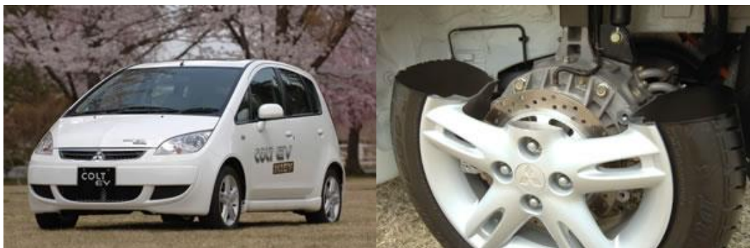
รูปที่ 2.17 รถยนต์รุ่น Colt EV (In-wheel motor test vehicle) และมอเตอร์คู่มือใน Colt EV
