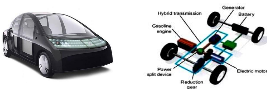
รูปที่ 2.11 รถยนต์ไฮบริดและโครงสร้างหลัก
