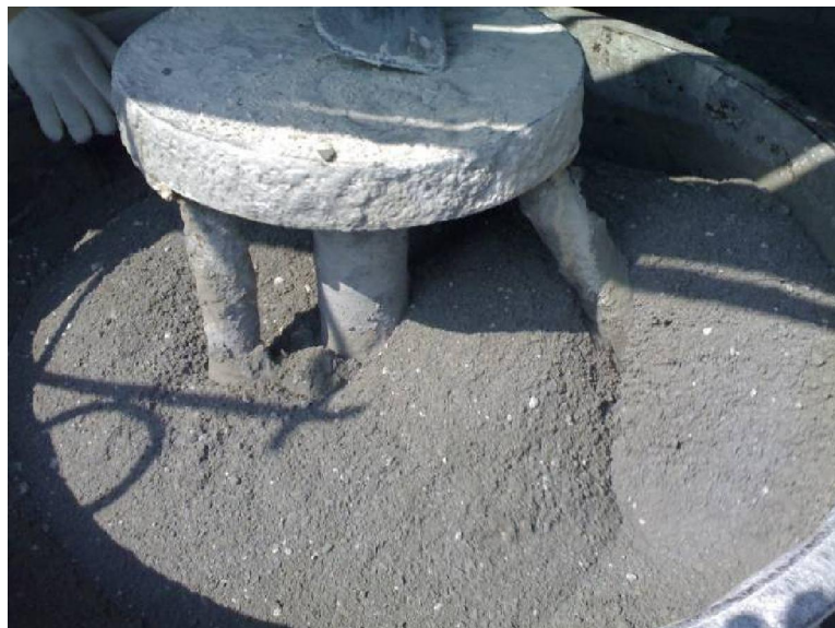
รูปที่ 3.3 ตัวอย่างการผสมวัตถุดิบของคอนกรีตบล็อกเก่าเคลบด้วยเครื่องผสมคอนกรีต
