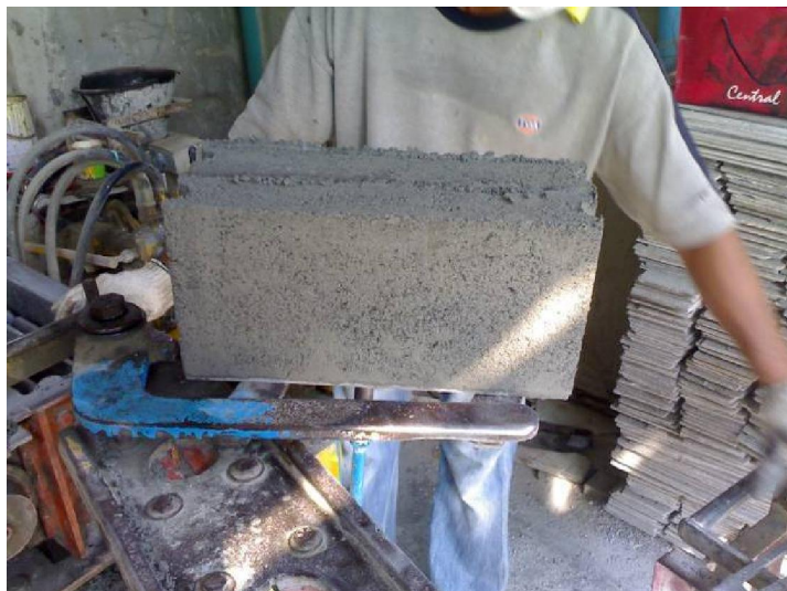
รูปที่ 3.5 ตัวอย่างคอนกรีตบล็อกเก้าแกลบที่ได้จากการขึ้นรูปด้วยเครื่องอัดไฮดรอลิก
