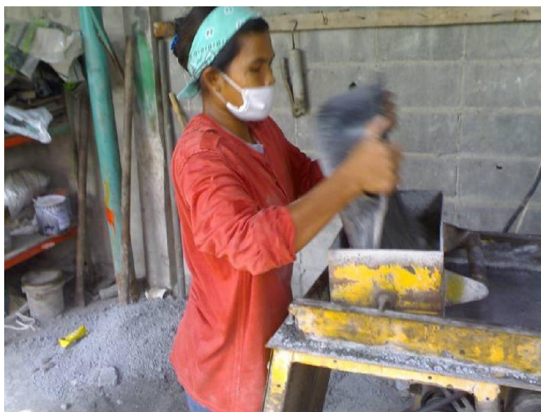
รูปที่ 3.4 ตัวอย่างการขึ้นรูปคอนกรีตบล็อกเก่าเคลบด้วยเครื่องอัดไฮดรอลิก
