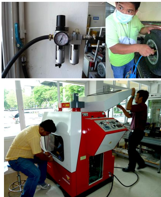
รูปที่ 3.23 การเติมลมยางและปิดประตูเครื่อง
