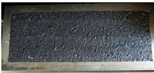
รูปที่ 3.21 ก้อนตัวอย่างที่ได้จากการเตรียมด้วยเครื่อง Plate Compactor
