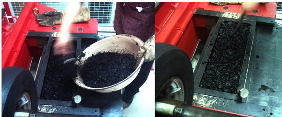
รูปที่ 3.20 การนำแอสฟัลต์คอนกรีตใส่เครื่อง Plate Compactor
