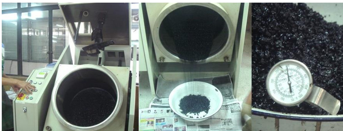
รูปที่ 3.19 การผสมแอสฟัลต์คอนกรีตด้วยเครื่องผสม
