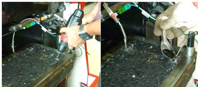
รูปที่ 3.29 การเจาะก้อนตัวอย่างเพื่อติดตั้งอุปกรณ์วัดอุณหภูมิและการหยอดยาง
