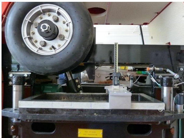
รูปที่ 3.18 การติดตั้งแม่พิมพ์เปล่าพร้อมการวัดค่าความลึก
