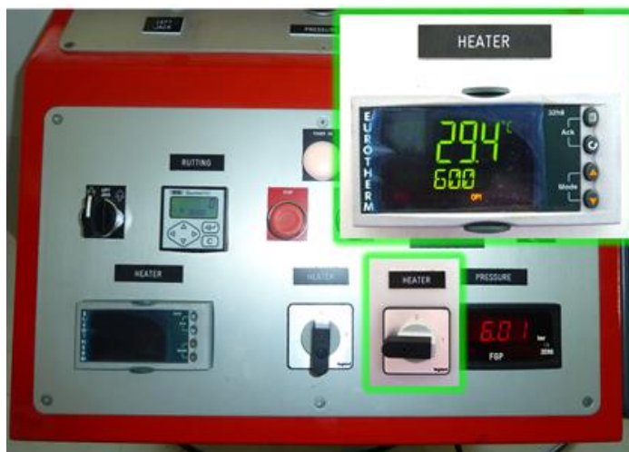
รูปที่ 3.30 การตั้งค่าและการเปิด Heater ให้ความร้อน
