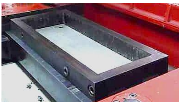
รูปที่ 3.8 แม่พิมพ์ใช้เตรียมตัวอย่างก่อนทดสอบ
