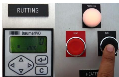
รูปที่ 3.25 การตั้งค่าจำนวนรอบและปุ่มการทำงาน (Run)
