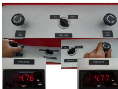
รูปที่ 3.24 การปรับค่าแรงดันไฮดรอลิกเพื่อดันแผ่นรองก้อนตัวอย่าง
