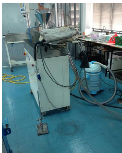
รูปที่ 3.18 เครื่อง Themo Haaker Polydrive (Single Screw Extruder)
