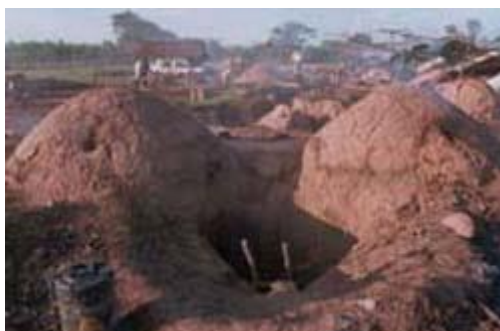
รูปที่ 2.14 ลักษณะของเตาดินเหนียวก่อ [3]
