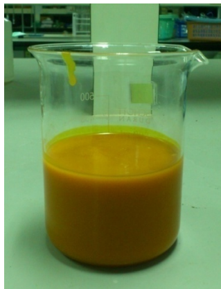
รูปที่ 3.1 น้ำมันปาล์มดิบที่ใช้เป็นวัตถุดิบในการทดลอง
