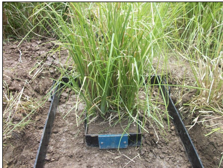
ภาพที่ 3.11 การประกอบ Shear Box เข้ากับก้อนดินตัวอย่าง
