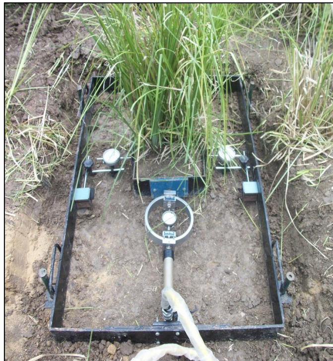
ภาพที่ 3.12 การติดตั้งชุด Dial Gage
