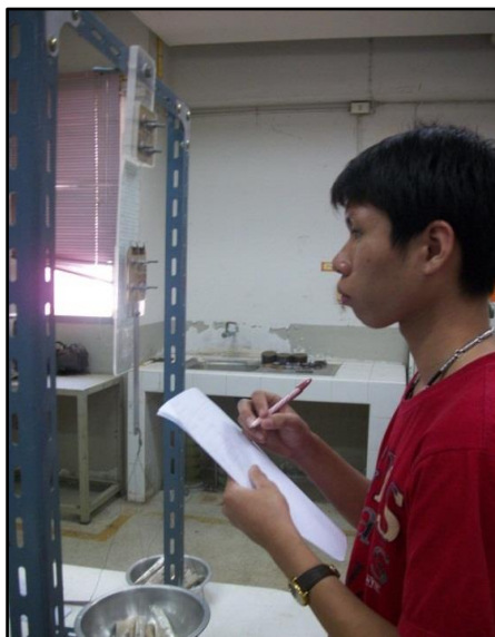
ภาพที่ 3.23 อ่านค่าและจดบันทึกจนกระทั่งตัวอย่างรากหญ้าเกิดการฉีกขาด
