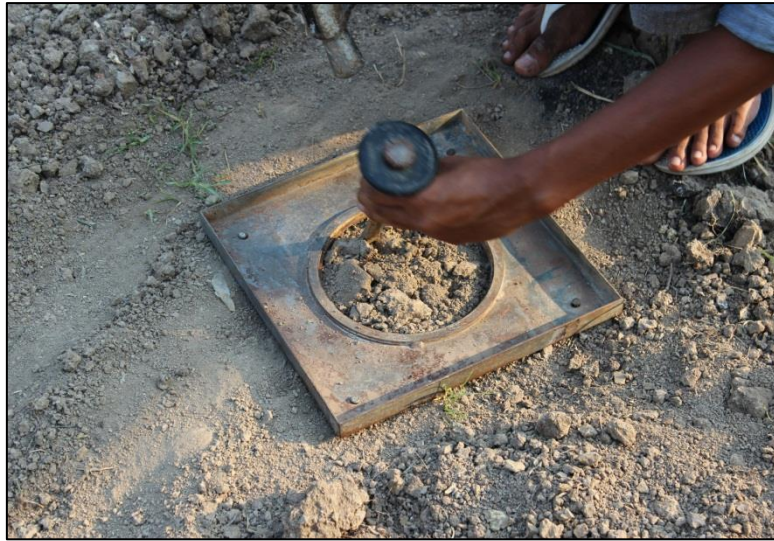
ภาพที่ 3.19 ชุดหลุมกลมจนได้ความลึกพอเหมาะ
