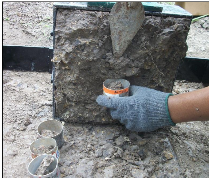
ภาพที่ 3.17 การเก็บตัวอย่างดินเพื่อหาปริมาณความชื้น
