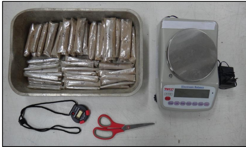
ภาพที่ 3.9 ถุงน้ำหนักบรรจุทรายแห้งและเครื่องชั่งละเอียด
