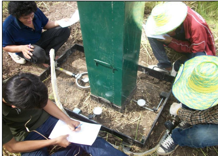
ภาพที่ 3.15 การทดสอบแรงเหวี่ยงโดยตรงในสนาม
