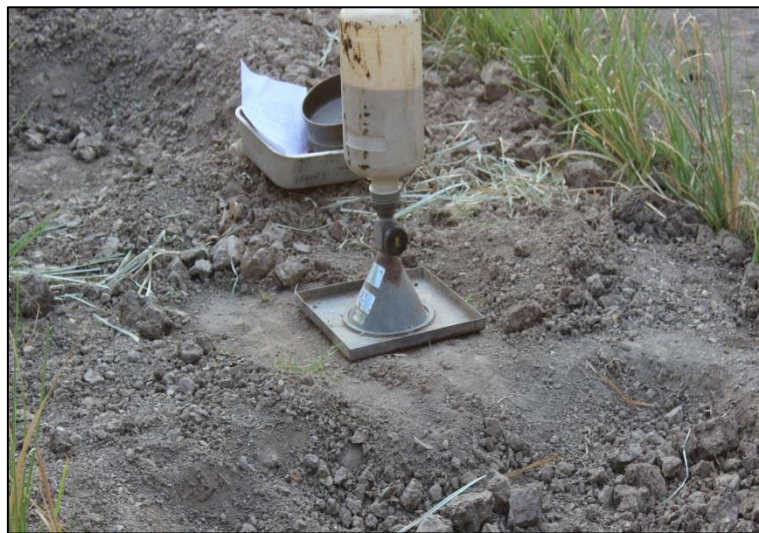
ภาพที่ 3.20 คว่ำกรวยทรายให้ขอบกรวยทรายวางอยู่บนบ่าแผ่นหาความหนาแน่น
