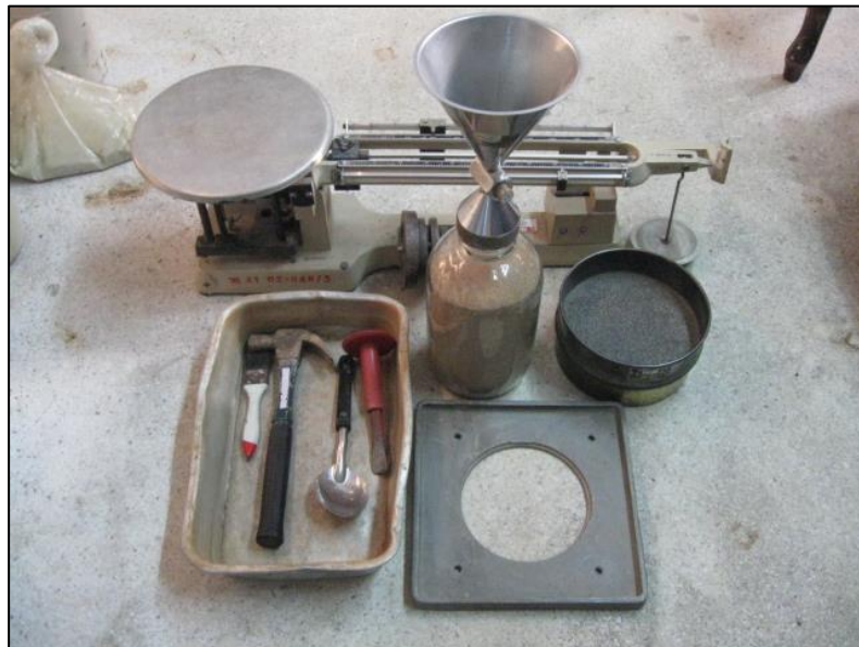
ภาพที่ 3.7 เครื่องมือทดสอบหาค่าความหนาแน่นในสนาม
