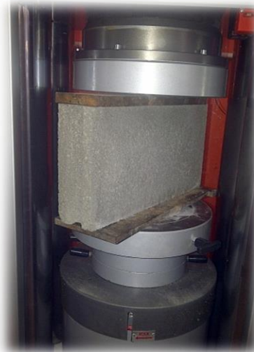
รูปที่ 3.27 การทดสอบกำลังอัดประลัยของคอนกรีตบล็อก
