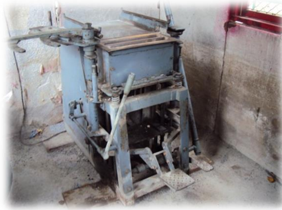
รูปที่ 3.9 เครื่องขึ้นรูปบล็อกคอนกรีต
