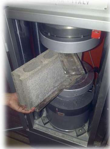
รูปที่ 3.26 การทดสอบกำลังอัดประลัยของคอนกรีตบล็อกวางแบบหงายรูขึ้น 3) ปล่อน้ำหนักกลงมาที่ก้อนคอนกรีตบล็อกจนแตก แล้วบันทึกค่า
