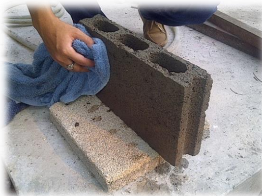
รูปที่ 3.30 บล็อกคอนกรีตหลังจากแช่น้ำ
