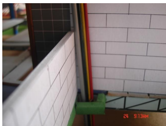
รูปที่ 4.39 แสดงการทำคานช่องท่อน้ำจากห้องน้ำชั้นบน
