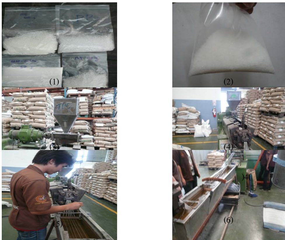
รูปที่ 3.2 การผสมโพลิเมอร์ผสมระหว่าง PP/POE/ \text{CaCO}_3 /POE-G ตามสูตรที่กำหนด
