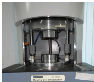
รูปที่ 3.10 แสดงการทดสอบการหาอุณหภูมิและเวลาคงรูปของยางด้วยเครื่อง Moving Die Rheometer
