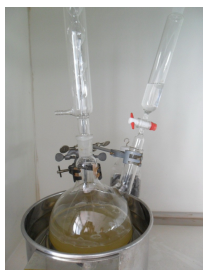
รูปที่ 3.2 แสดงแผนการเตรียมยางธรรมชาติกราฟท์โพลีอะคริโลไนไตรล์
