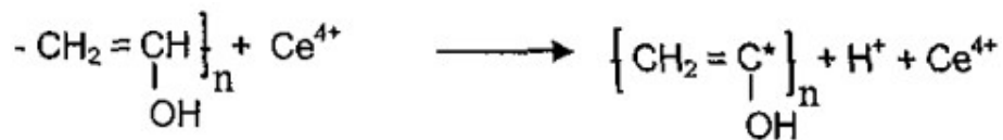
รูปที่ 2.8 แสดง Redox Initiation ของโพลีไวนิลแอลกอฮอล์กับซิริคไอออน
