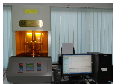
รูปที่ 3.11 แสดงการทดสอบการหาความหนืดของยาง ด้วยเครื่อง Mooney Viscometer
