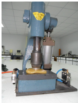
รูปที่ 3.11 แสดงการทดสอบการหาความหนืดของยาง ด้วยเครื่อง Mooney Viscometer
