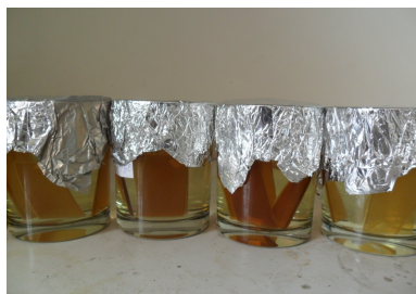
รูปที่ 3.14 แสดงการทดสอบการบวมตัว
