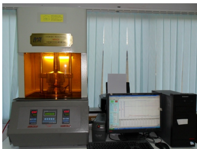
รูปที่ 2.21 แสดงเครื่องทดสอบ Mooney viscometer
