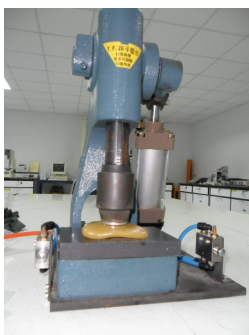
รูปที่ 3.10 แสดงการทดสอบการหาอุณหภูมิและเวลาคงรูปของยางด้วยเครื่อง Moving Die Rheometer
