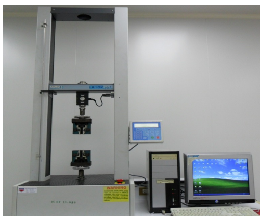
รูปที่ 2.16 แสดงรูปร่างเครื่อง Universal Testing Machine
