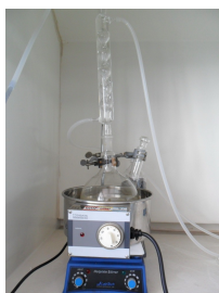
รูปที่ 3.1 แสดงแผนผังการเตรียมยาง NR-g-AN
