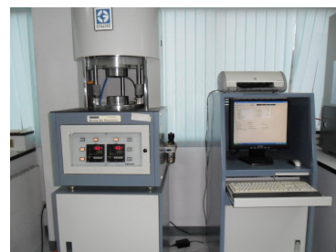
รูปที่ 3.10 แสดงการทดสอบการหาอุณหภูมิและเวลาคงรูปของยางด้วยเครื่อง Moving Die Rheometer
