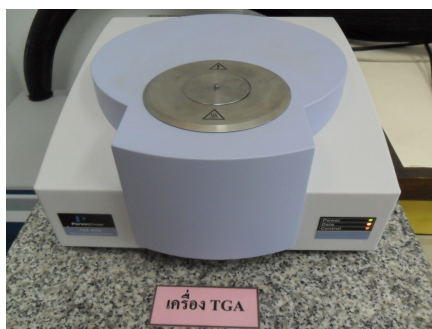
รูปที่ 2.20 แสดงเครื่องทดสอบสมบัติทางความร้อน (Thermogravimetric Analysis; TGA)
