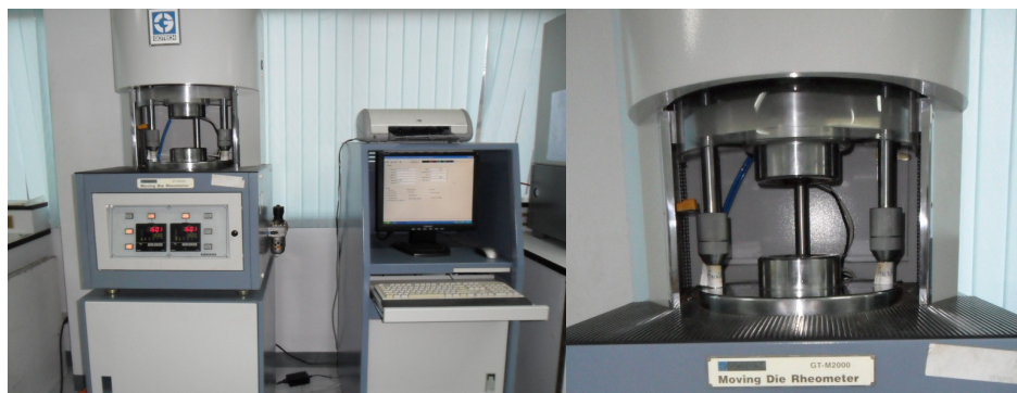
รูปที่ 2.11 แสดงเครื่อง Moving Die Rheometer(MDR)
