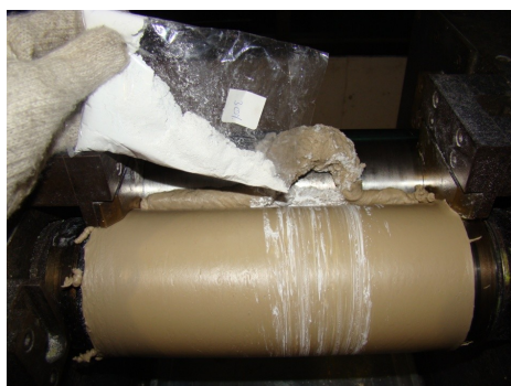
รูปที่ 3.5 แสดงการใส่สารเติมแต่งและขึ้นรูปยางคอมปาวด์
