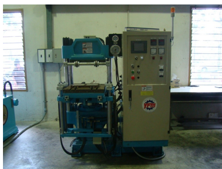
รูปที่ 3.6 แสดงการเครื่องอัดขึ้นรูปยางคอมปาวด์
