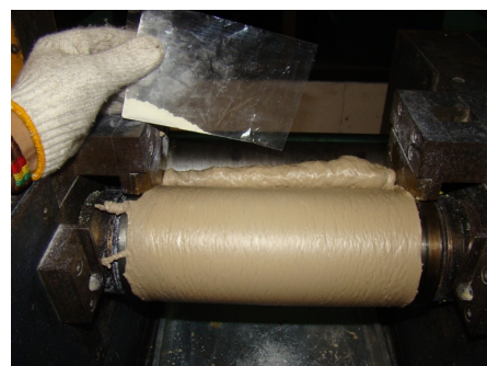
รูปที่ 3.5 แสดงการใส่สารเติมแต่งและขึ้นรูปยางคอมปาวด์
