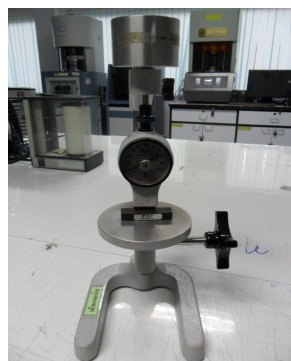
รูปที่ 3.12 แสดงเครื่องมือการทดสอบความแข็งแบบ Durometer Hardness (shore A)
