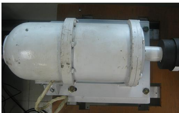
รูปที่ 4.16 เครื่องกำเนิดไฟฟ้าแบบซิงโครนัสแม่เหล็กถาวร 3 เฟส
