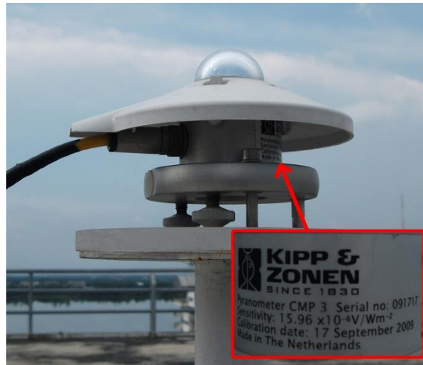
รูปที่ 3.4 ไพรานอมิเตอร์บนศาลฟ้าอาคาร
