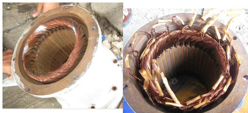
รูปที่ 3.28 สเตเตอร์ของกังหันลมผลิตไฟฟ้า
