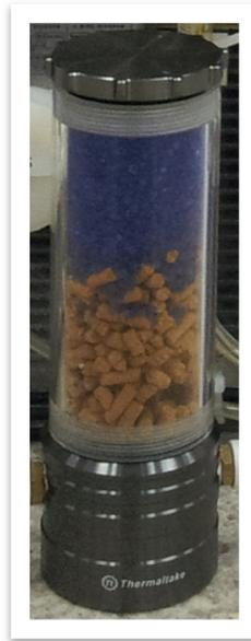
รูป 3.13 การบรรจุ Silica gel เพื่อลดความชื้น (ชั้นบน) และ Fours Oxide เพื่อลดปริมาณ  $H_2S$  (ชั้นล่าง)
