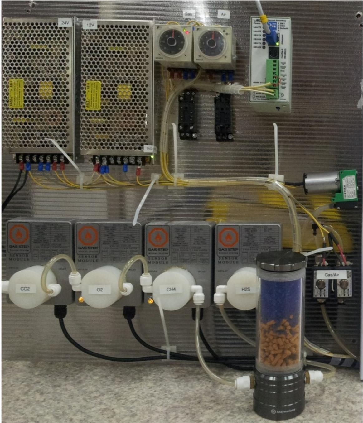
รูป 3.15 การต่อ Diaphragm Pump, Gas Treatment, Sensors, Timer, และ Power Supply
