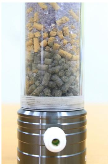
รูป 5.1 Ferric Oxide Desulfurizer หลังจากผ่านการใช้งาน 280 ชั่วโมง ที่มี  $\text{H}_2\text{S}$  เฉลี่ย 300 ppm
