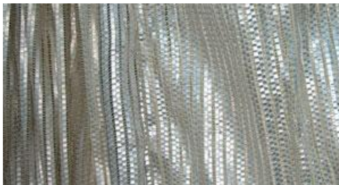
รูปที่ 2.13 อลูมิเนียมอลูมินेत (aluminet) เป็นตาข่ายพรางแสงชนิดเคลือบหรือหุ้มด้วยพลาสติกใส
