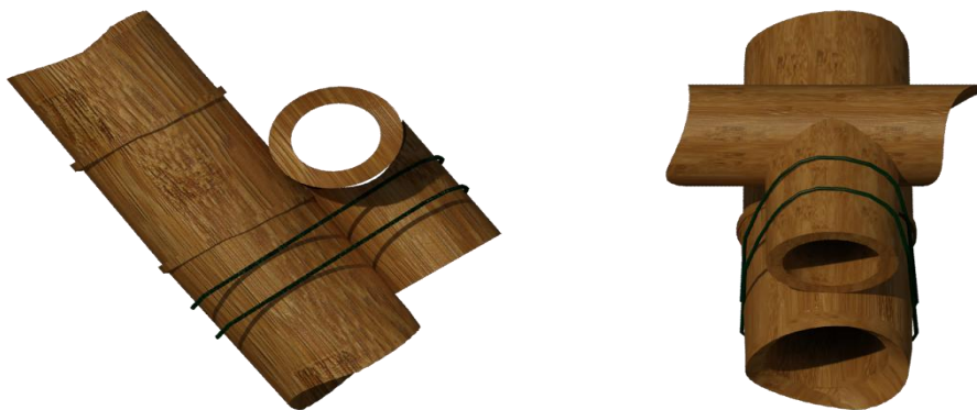
รูปที่ 5.15 แสดงการทำข้อต่อของโครงสร้างหลังคากระหว่างจันทันกับแปที่ใช้ตอกไม้ไผ่ หวาย เชือกหรือลวดยึดโครงสร้าง
