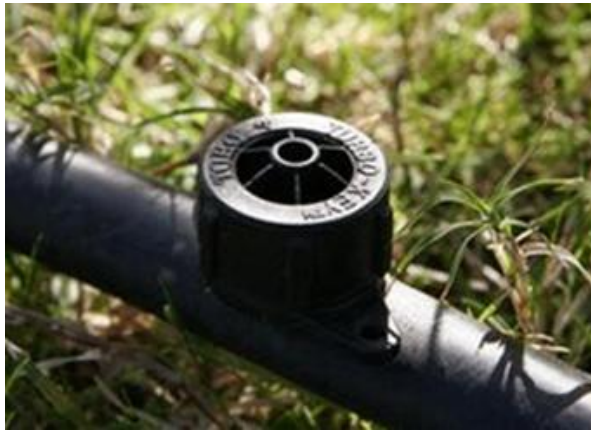
รูปที่ 5.26 หัวน้ำหยดบนผิวดิน – ปักตามระยะที่เราต้องการ -ปรับปริมาณน้ำได้-ถอดเปลี่ยนได้อัตราการไหล 4-10 ลิตร/ชั่วโมง
