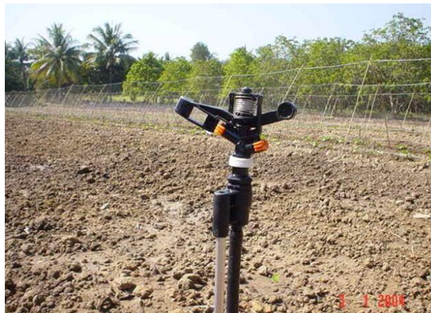
รูปที่ 5.27 ระบบสปริงเกอร์ขนาดเล็ก รัศมี 8 เมตร อัตราการไหล 400 ลิตร/ชั่วโมงพื้นที่ 2 ไร่ ใช้ประมาณ 40 หัวจ่ายอัตราการให้น้ำประมาณ 5 มิลลิเมตร/ชั่วโมง
