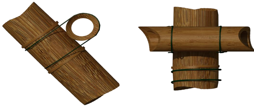
รูปที่ 5.14 แสดงการทำข้อต่อของโครงสร้างหลังคากระหว่างจันทันกับแปที่ใช้ตอกไม้ไผ่ หวาย เชือกหรือลวดยึดโครงสร้าง
