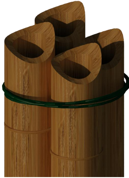
รูปที่ 5.3 แสดงโครงสร้างเสาที่ใช้ไม้ไผ่ขนาดเล็กมัดรวมกันเพื่อเพิ่มการรับน้ำหนักได้มากขึ้นโดยเจาะด้วยสว่าน แล้วยึดน๊อต หรือใช้สลักยึดแล้วใช้เชือกมัดให้แน่น
