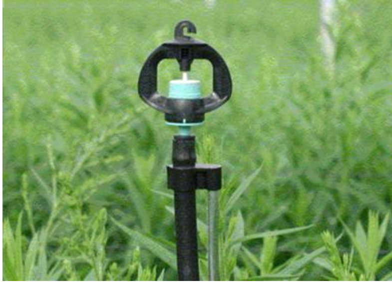
รูปที่ 5.28 ระบบมินิสปริงเกลอร์แบบหัวเหวี่ยง อัตราการจ่ายน้ำ 35-200 ลิตร/ชั่วโมง เหมาะกับไม้ผล พืชผักที่ปลูกชิดติดกัน รัศมีการให้น้ำ 2 –5 เมตร ควรใช้ร่วมกับกรองน้ำเพื่อป้องกันการอุดตัน
