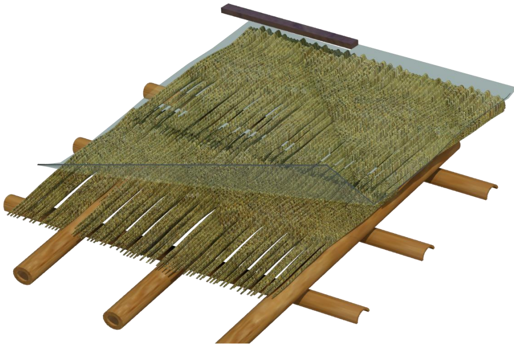
รูปที่ 5.22 หลังคามุงหญ้าคาหรือแฝก ปูพลาสติกทับอีกชั้นและใช้ไม้วางทับพลาสติกหรือรัดด้วยสายรัดวิธีนี้ใช้ เพื่อป้องกันการรั่วซึม ของน้ำฝน และเพิ่มอายุการใช้งานของหลังคา
