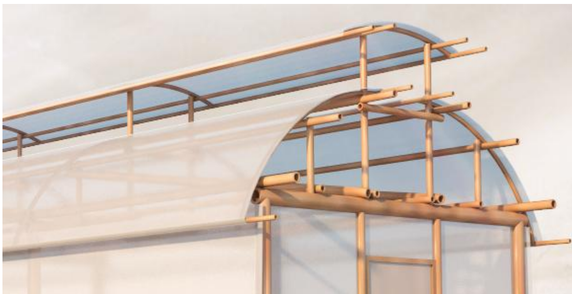
รูปที่ 5.23 โรงเรือนปลูกพืช หลังคาและผนังมุงพลาสติก เก็บริมขอบด้วยไม้ไผ่ขนาดเล็กหรือท่อพีวีซี
