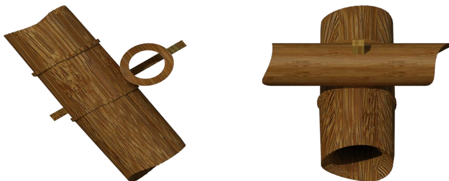
รูปที่ 5.16 แสดงการทำข้อต่อของโครงสร้างหลังคากระหว่างจันทันกับแปที่ใช้สลัก หรือเดือยไม้ไผ่ยึดโครงสร้าง แทนตะปู หรือน็อตในบริเวณที่โคนน้ำฝน
