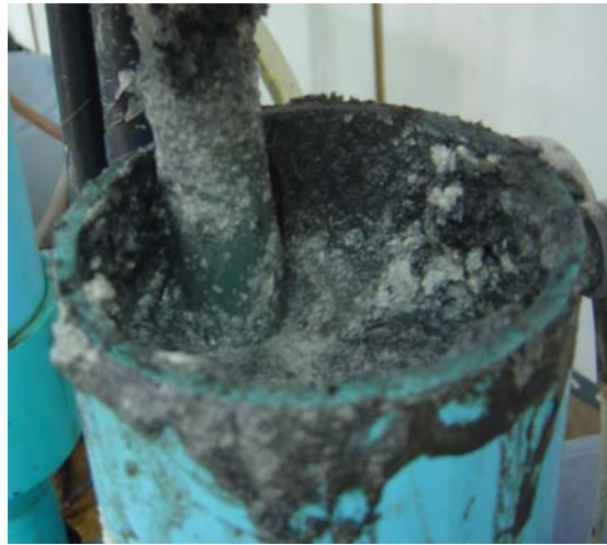
รูปที่ 4.1 สภาวะตะกอนลอยในถังปฏิกรณ์ยูเอเอสบีชุดที่ 1 และ 2
