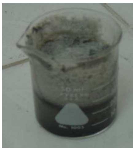
รูปที่ 4.36 ลักษณะตะกอนแบคทีเรียที่ลอยอยู่ด้านบนถังปฏิกรณ์ยูเอเอสพี และถังปฏิกรณ์เอสปีอาร์ไร้อากาศชุดที่ 1 และ 2
