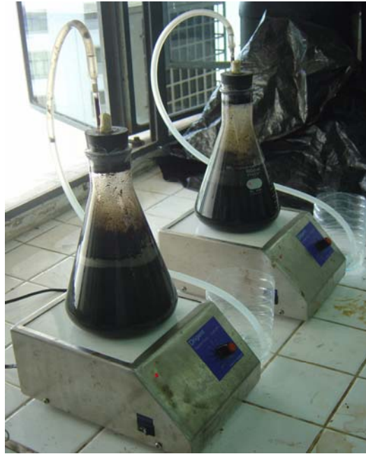
รูปที่ 3.3 ชุดแบบจำลองถังปฏิกรณ์เอสปีอาร์ไร้อากาศ (AnSBR reactor) ชุดที่ 1 และ 2
