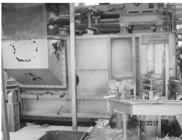
รูปที่ 3.7 เตาหลอมโลหะขนาด 15 ตัน
