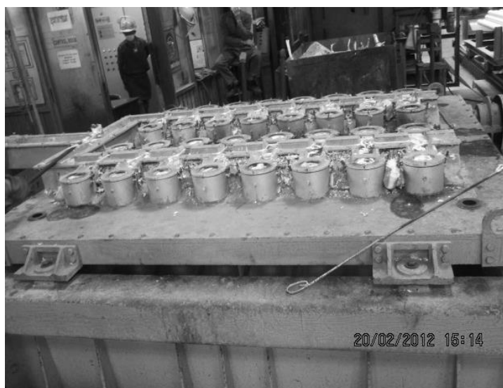
รูปที่ 3.10 แบบสำหรับการผลิตบิลเลทอะลูมิเนียม
